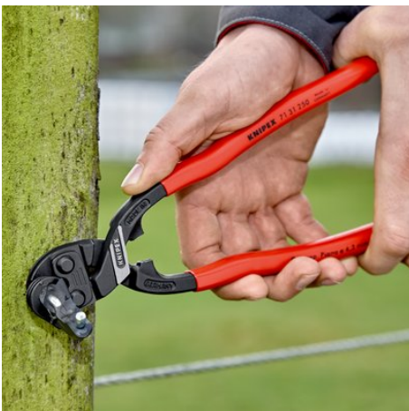
работа двумя руками для достижения максимальной силы резания
