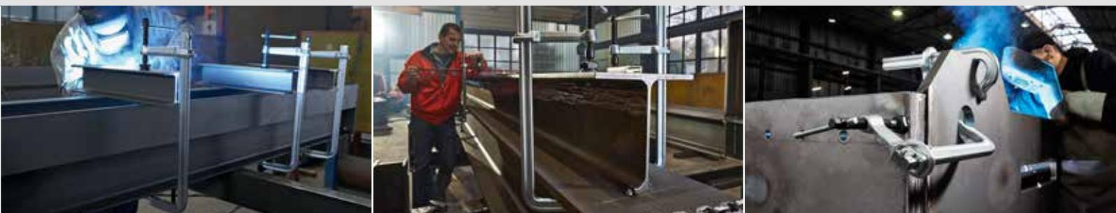
**Оптимизированный профиль направляющей – зажимное усилие до 12000 Н**
